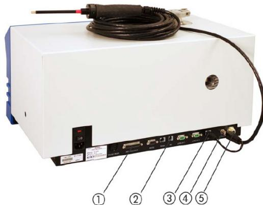
① 外控 IO 接口 ② 遥控接口 ③ 吸枪控制接口 ④ 放气 / 吸枪接口 ⑤ 前级泵排气口
