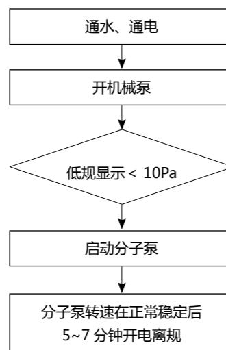
实验结束后，先关闭真空计电离部分，然后停分子泵，待分子泵停稳后停机械泵。切记要最后关闭真空计电源。关闭分子泵电源。关闭系统控制总电源。关水、关气。
